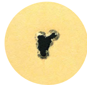
Schussbild 1827 F ANSCHÜTZ 5 Schuss .22 l.r. auf 50 m bei -30^{\circ}\text{C} . 5-shot 1827 F ANSCHÜTZ test fire group at 54.68 yards at -22^{\circ}\text{F} .
