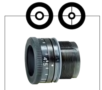
Super-Irisringkorn 9740 Ø 2,8 - 4,8 mm, verstellbar. Das Durch- sichtsbild kann mit einem mitgelieferten Werkzeug von Fadenkreuz auf Quer- balken verstellbar und somit den Wünschen des Schützen individuell angepasst wer- den. Dieses Ringkorn wird zusätzlich mit einem größeren Rändelring geliefert, um das Zielbild besser abdecken zu können. Das ANSCHÜTZ Super-Iris-Ringkorn wird mit Einschraubgewinde M18 x 0,5 mm geliefert.
