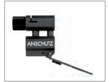
Kornstempel Biathlon 6865, höhenverstellbar inkl. Visierlinienerhöhung um 8 mm. Biathlon front sight 6865, adjustable in height incl. rear sight elevation 0.31 inch. Best.-Nr.: 011360
