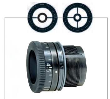
Super-Irisringkorn 9740 Ø 2,8 - 4,8 mm, verstellbar. Das Durchsichtsbild kann mit einem mitgelieferten Werkzeug von Fadenkreuz auf Querbalken verstellt und somit den Wünschen des Schützen individuell angepasst werden. Dieses Ringkorn wird zusätzlich mit einem größeren Rändelring geliefert, um das Zielbild besser abdecken zu können. Das ANSCHÜTZ Super-Iris-Ringkorn wird mit Einschraubgewinde M18 x 0,5 mm geliefert.
